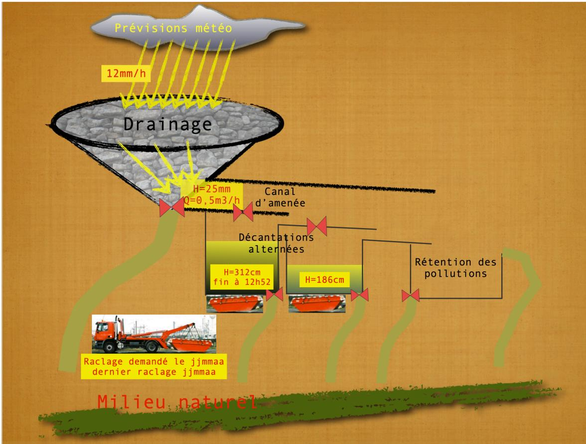
Hors le génie civil des bassins et canaux d'écoulement (hors programme), un site comprend des équipements électromécaniques et électroniques :
